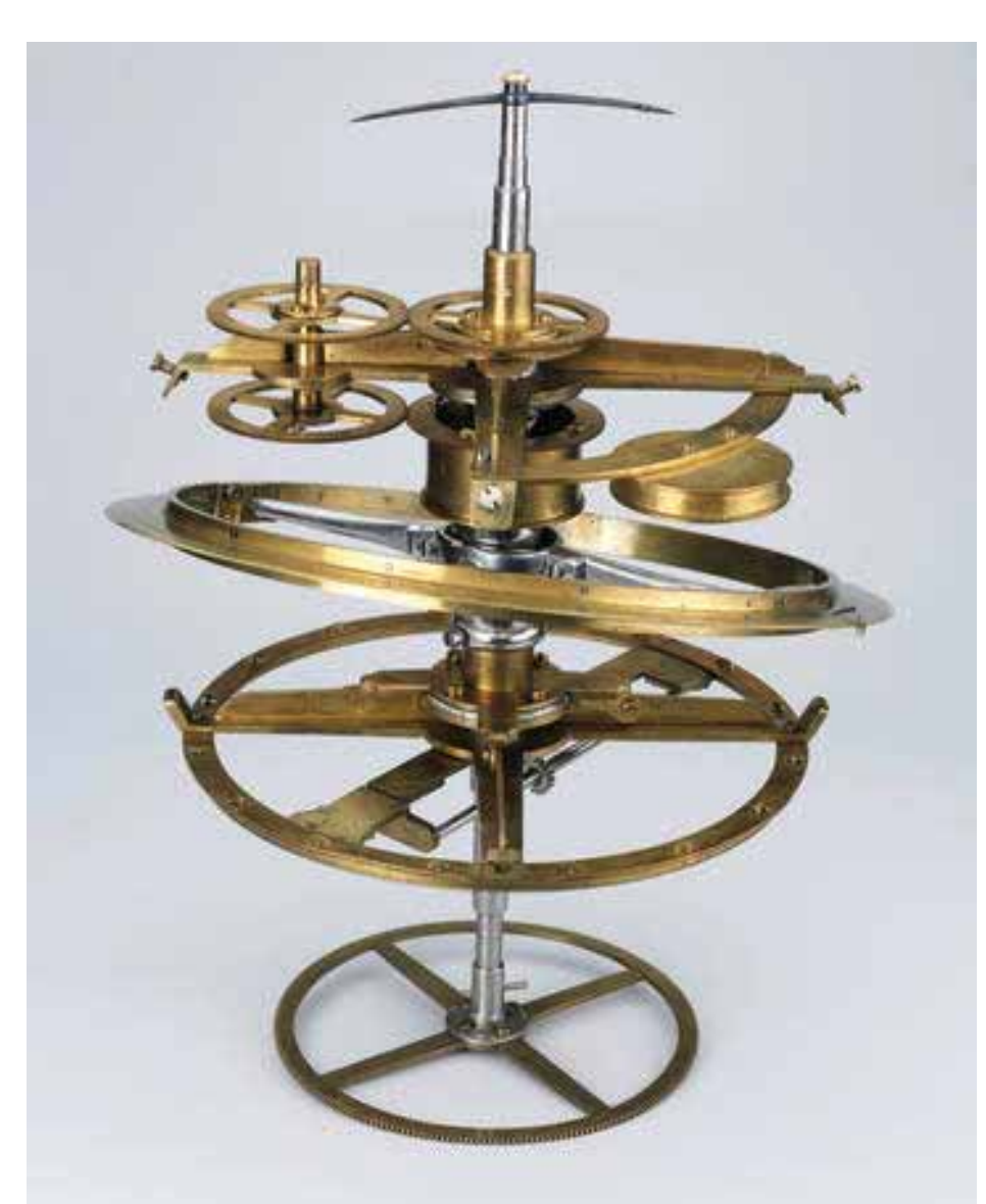
Planetensystem des Ptolemäus als Uhrwerk
